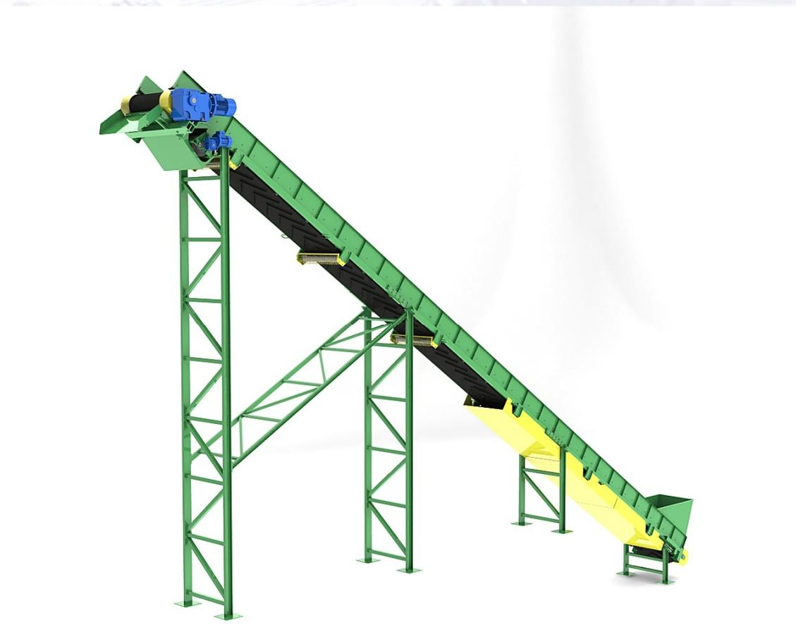
Конвейер ленточный шевронный наклонный предназначен для перемещения сыпучих материалов (древесных опилок, щепы, торфа и пр.).
