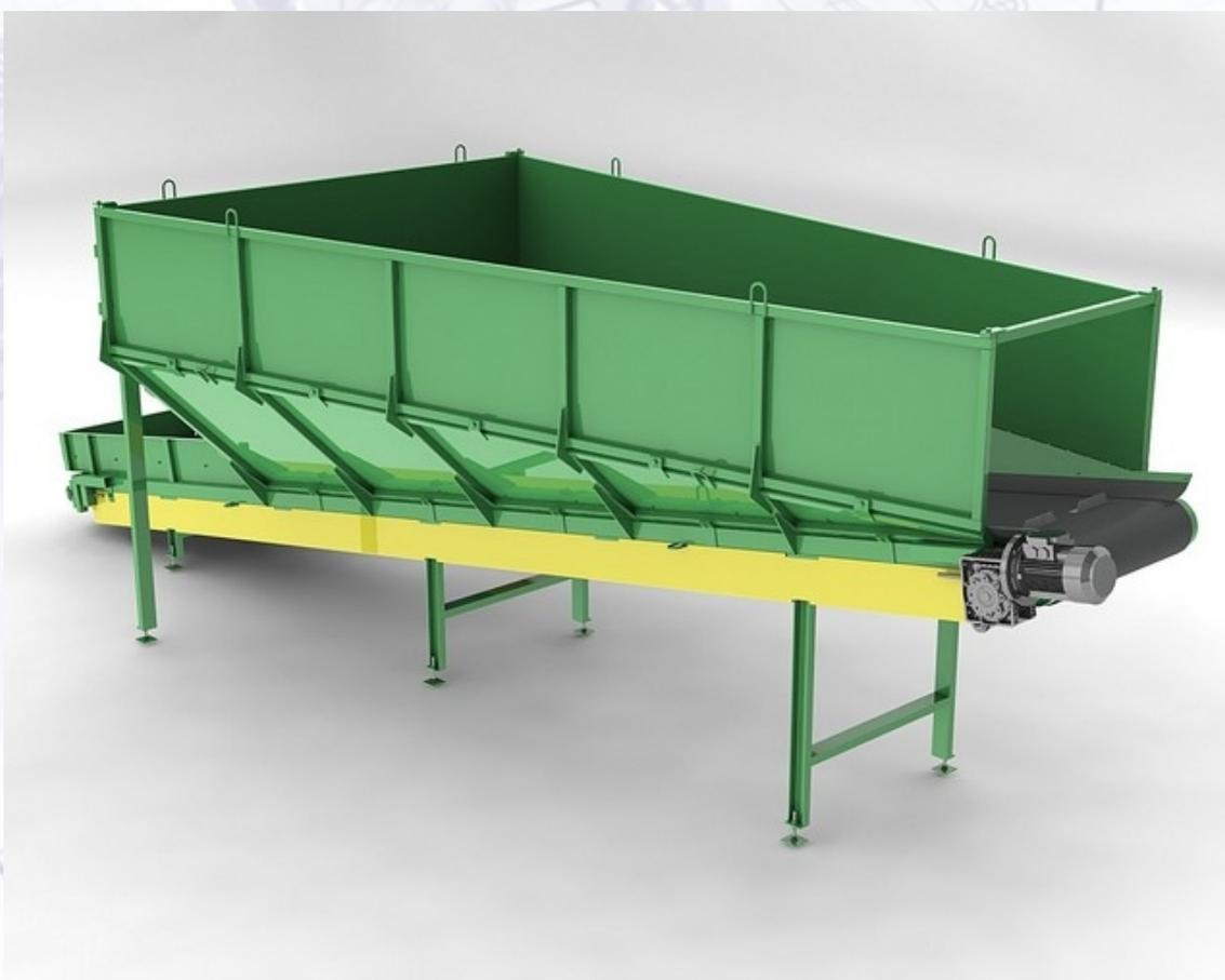
Конвейер ленточный с бункером входит в состав линии прессования ПЭТ-бутылок и картона. Конвейер предназначен для перемещения картона, макулатуры с бункера конвейера и [перфоратора ПЭТ-бутылок мобильного \(УЖИМ 546.00.000 -07\)](#) в [пресс гидравлический горизонтальный \(УЖИМ 527.00.00.000\)](#).
