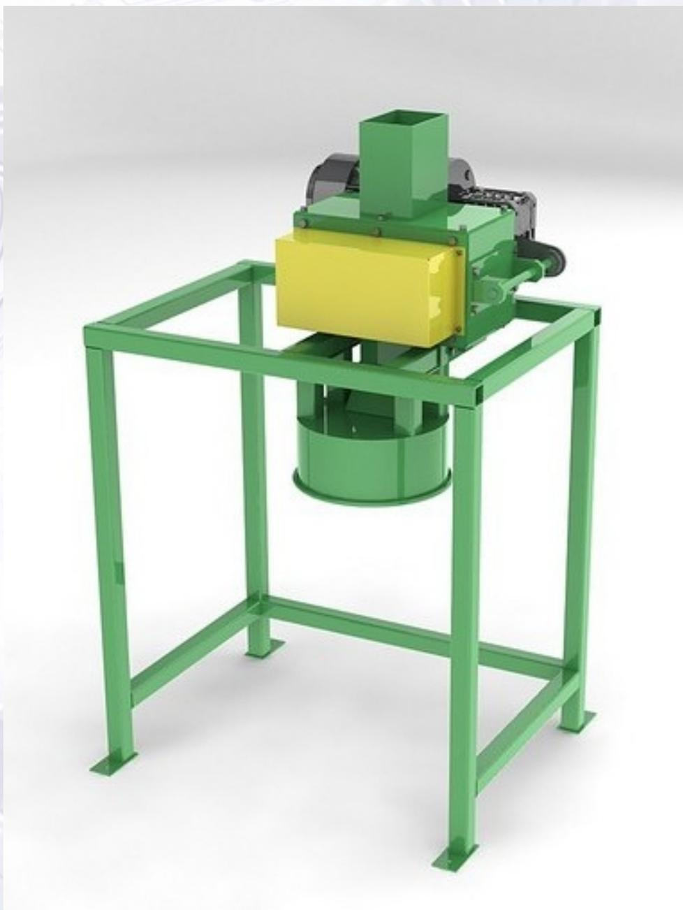
Дробилка валковая предназначена для дробления медицинских ампул с последующим разделением содержимого ампул и стекла. Дробленое стекло собирается в мешок, а жидкость сливается из поддона дробилки, через шланг, в сосуд.
