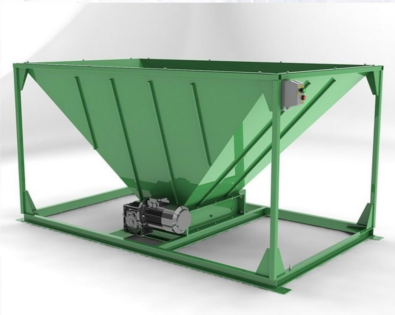
Перфоратор предназначен для прокалывания ПЭТ-бутылок с целью дальнейшего прессования.
