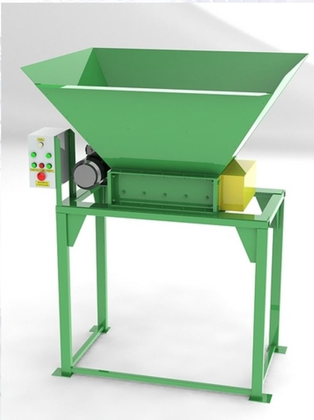
Перфоратор предназначен для прокалывания ПЭТ-бутылок с целью дальнейшего прессования.
