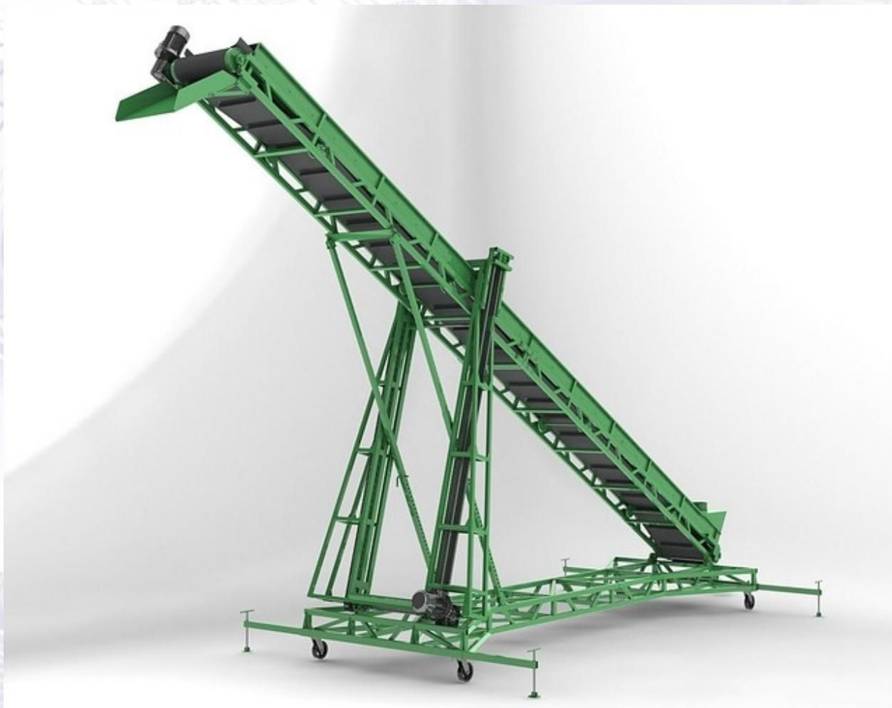
Конвейер ленточный передвижной с изменяющейся высотой разгрузки предназначен для перемещения сыпучих материалов на высоту до 5600 мм. Может эксплуатироваться на открытом воздухе при температуре окружающей среды от -30°C до +30°C.
