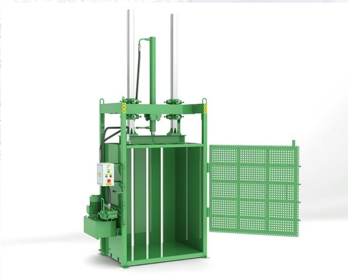
Пресс предназначен для отжима влажной ветоши, волокнистых, пористых, вспененных легкосжимаемых материалов, отходов производства полиэтиленовой и полипропиленовой пленки в тюки требуемого размера, плотности и веса, и удобства дальнейшей упаковки и/или транспортировки любым видом транспорта к месту переработки.
