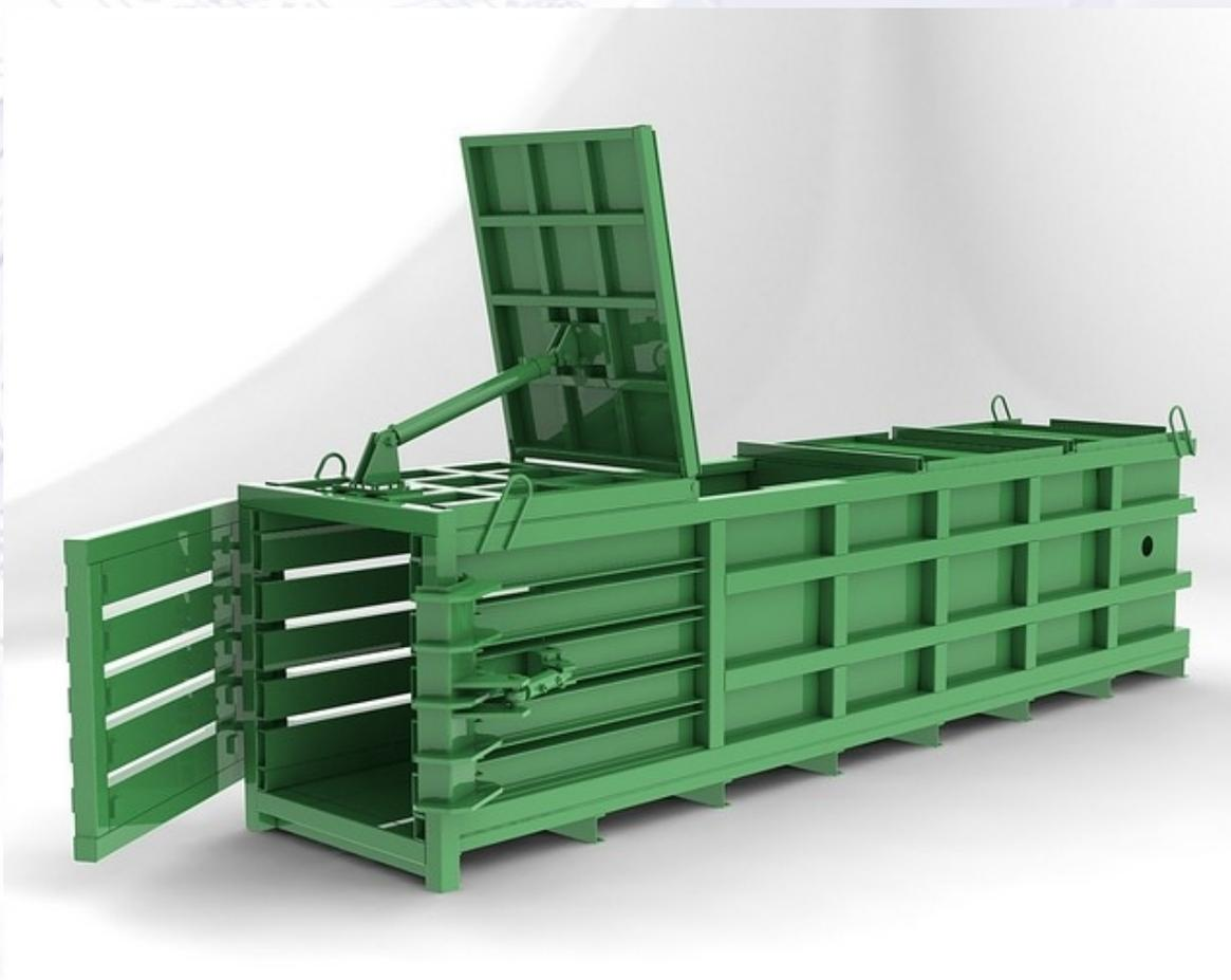
Пресс предназначен для прессования макулатуры, картонных коробок и полимеров (пленки, ПЭТ-бутылки) на заготовительных предприятиях с большим объемом вторсырья.
