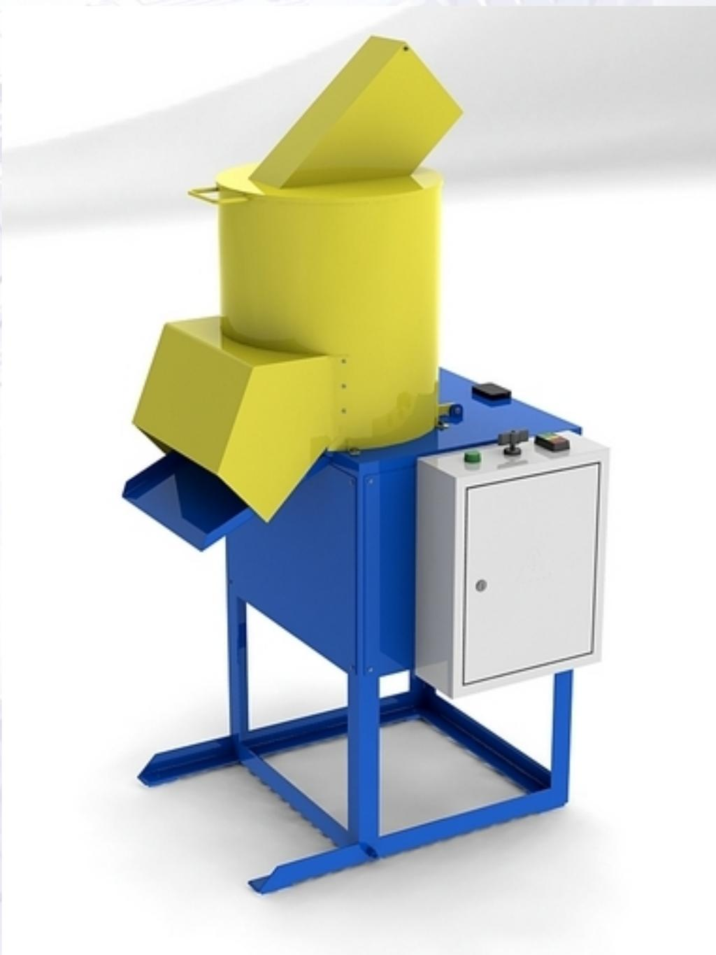
Дробилка предназначена для измельчения ПЭТ-бутылок.
